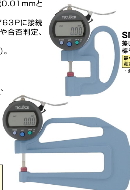
SMD-550J 差し込み深さ120mmのため、 シート状ワークの測定に有効 最小表示量0.01mm 測定範囲12mm ・測定子、アンビル ＝セラミック製
