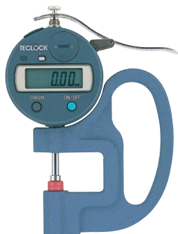
SMD-540S 差し込み深さ30mmの普及モデル 最小表示量0.01mm 測定範囲12mm ・測定子、アンビル ＝セラミック製
