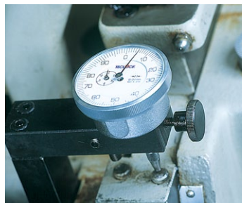
測定面の変位量が真上から読み取れます
