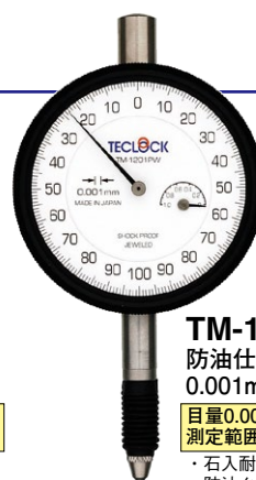
TM-1201 最もポピュラーな 0.001mmモデル 目量0.001mm 測定範囲1mm ・石入耐久型 ・ショックブルーフ ・焼入ステンレスシステム
