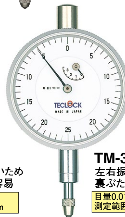
TM-35-04 小形ロング ステムタイプ 目量0.01mm 測定範囲5mm
