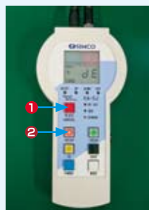
②ボタン選択後、①ボタンを押す(プラス減衰時間測定時) ③ボタン選択後、①ボタンを押す(マイナス減衰時間測定時)
