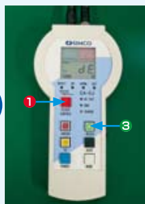
②ボタン選択後、①ボタンを押す(プラス減衰時間測定時) ③ボタン選択後、①ボタンを押す(マイナス減衰時間測定時)
