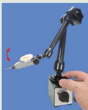
ワンタッチ手元微動送り機構 アームに触れずにゲージ針を微動送りさせるので、0合わせが簡単です
