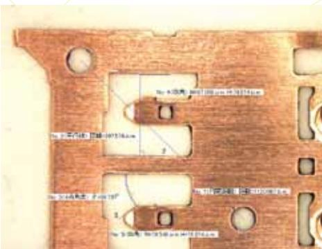
個々の計測コマンドにおいて画面上に表示される計測線はテンプレートとして保存（同一画面内で計測線が複数存在する場合は一括保存）できます。また、同一ワークを繰返し測定するような場合は、保存された計測テンプレートを呼び出し、表示された計測テンプレートにワークをおおよそ合わせるだけで、同一画面内の測定をすべて順次行うことができます。
