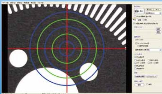
フルサイズ(最大)でライブ画像を表示できますので、モニタ上での外観検査に便利です。モニタ上に中心線・同心円などのレチクル表示も可能です。静止画・動画の撮影もでき、撮影時の各種設定(露光・ゲイン・シャッタースピード・ホワイトバランス・コントラストなど)ができます。
