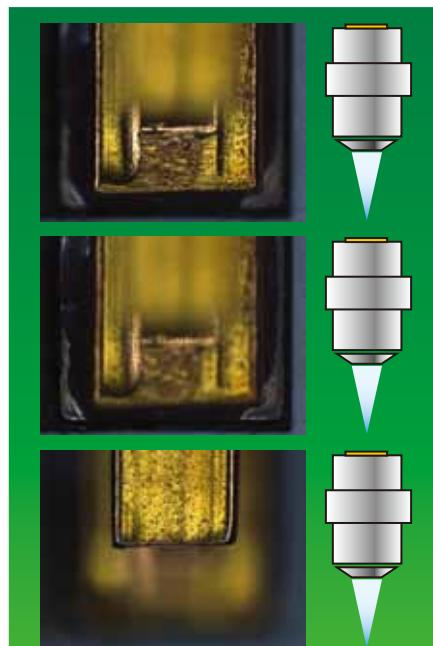
顕微鏡画像は焦点深度(ピントが合って見える範囲)が浅いため、被検物の全体像の把握が困難ですが、本システムではピントが異なる複数画像を合成し全域にピントが合った画像表示が可能です。
