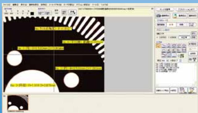
使用頻度が高い基本的な13種類の計測コマンドと自動エッジ検出機能※により汎用性が高い計測ができます。
