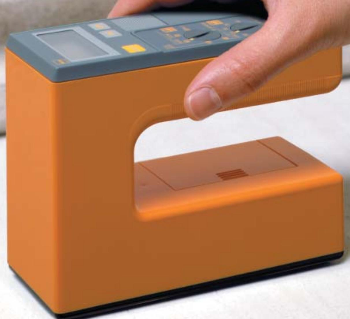
選択ダイヤルの省略文字、LWCは(Artificial Light Weight Aggregate Concrete)で人工軽量骨材コンクリート、GYPは(Gypsum Board)で石膏ボード、MORは(Mortar)でモルタル、CONは(Concrete)でコンクリート、ALCは(Autoclaved Lightweight Concrete)を表現しています。
