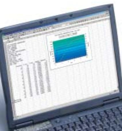
● FD-800はオプションの「データロガーソフト FDL-01」とMS ExcelをインストールしたPCと接続することで、リアルタイムに測定データをPCに転送し、保存することができます。また、取り込んだ測定データをグラフ化し視覚的に水分変化や温度状態を確認することができます。グラフは水分および、サーミスタ(T1)温度と放射温度計(T2)温度を表示することができます。<sup>\*2</sup>
