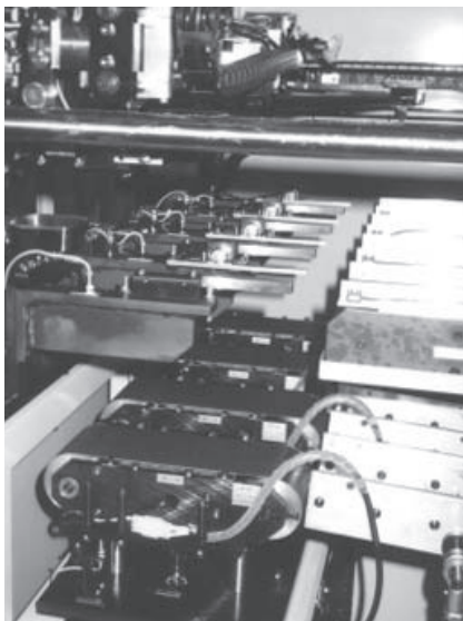
自社製ボールねじを駆使した選別収納部 Sorting and Stock station with our original “Ball Screws”.
